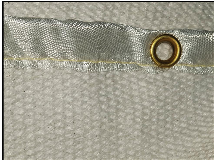
Detalle tela de fibra cerámica 600°C
